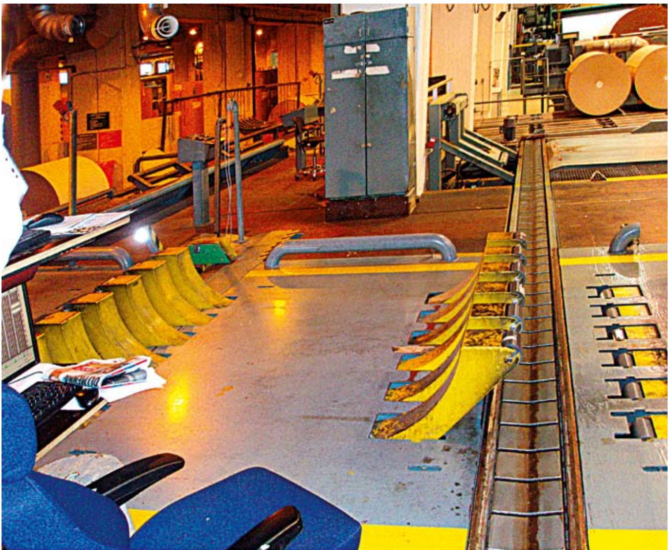
Kuva 4. Tapahtumapaikka koneenkäyttäjän ohjauspaikalta kuvattuna. NN:n työskenteli tapahtumahetkellä pakkausconeen keskitysaseman rullasiirtimen ja odotusaseman vastaanottimen välissä. NN:n mennessä tähän väliin ne olivat yläasennossa kuten kuvassa.
