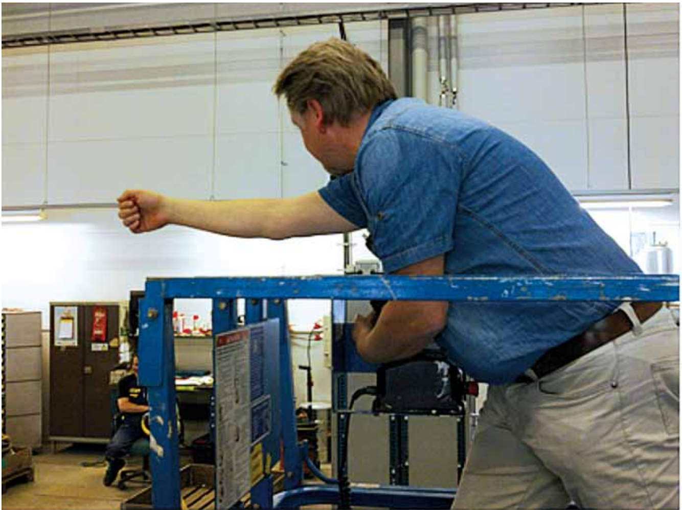
Kuva 1. Lavastettu todennäköisin tilanne tapaturmahetkellä, miten NN kurkotti vasaralla naulaa ja yritti samanaikaisesti siirtää saksilavaa eteenpäin.
