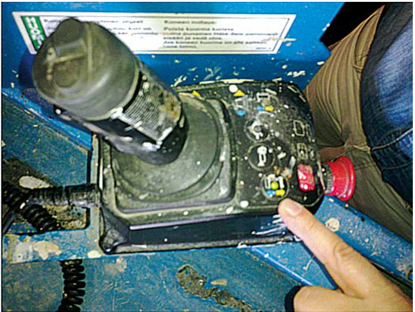
Kuva 2. Saksilavan hallintalaite ja painokytkin (sormi osoittaa), jolla ajoliike ja nostoliike vaihdettiin.
