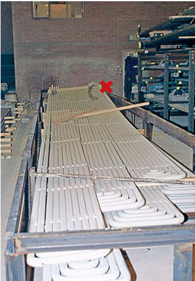
Kuva 2. Elementin suljettu pää ja sen jälkeen avoin pää putosivat alas. NN jäi pudonneen elementin ja pakkauskehikon reunan väliin (punainen rasti).
