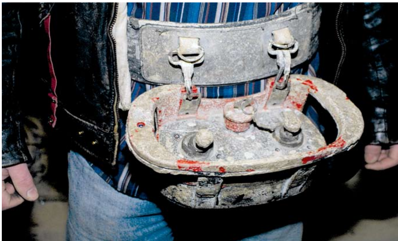
Kuva 5. NN:n käyttämä nosturin ohjainlaite.
