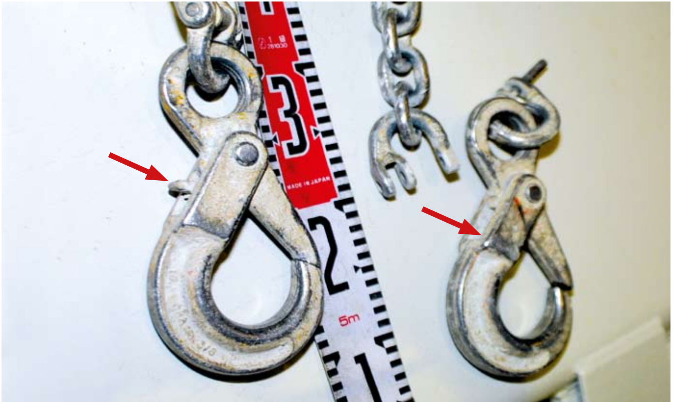
Kuva 6. Lähikuva ehjästä (vasemmalla) ja viallisesta (oikealla) nostokoukusta, josta puuttui turvasalvan lukitus.
