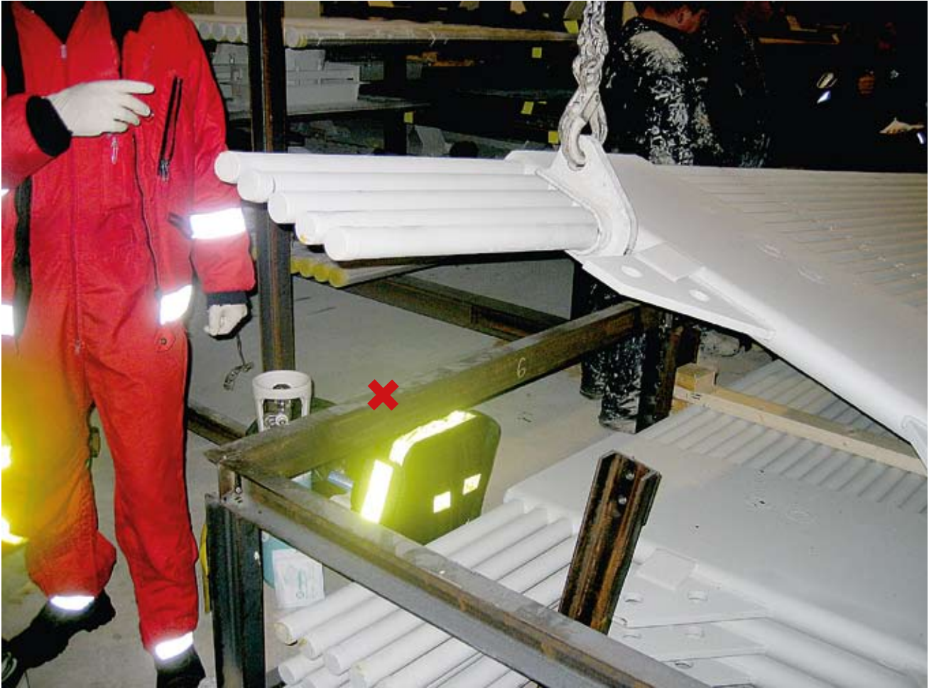
Kuva 3. Lähikuva tapahtumapaikasta. NN jäi pudonneen elementin ja pakkauskehikon reunan väliin (punainen rasti).
