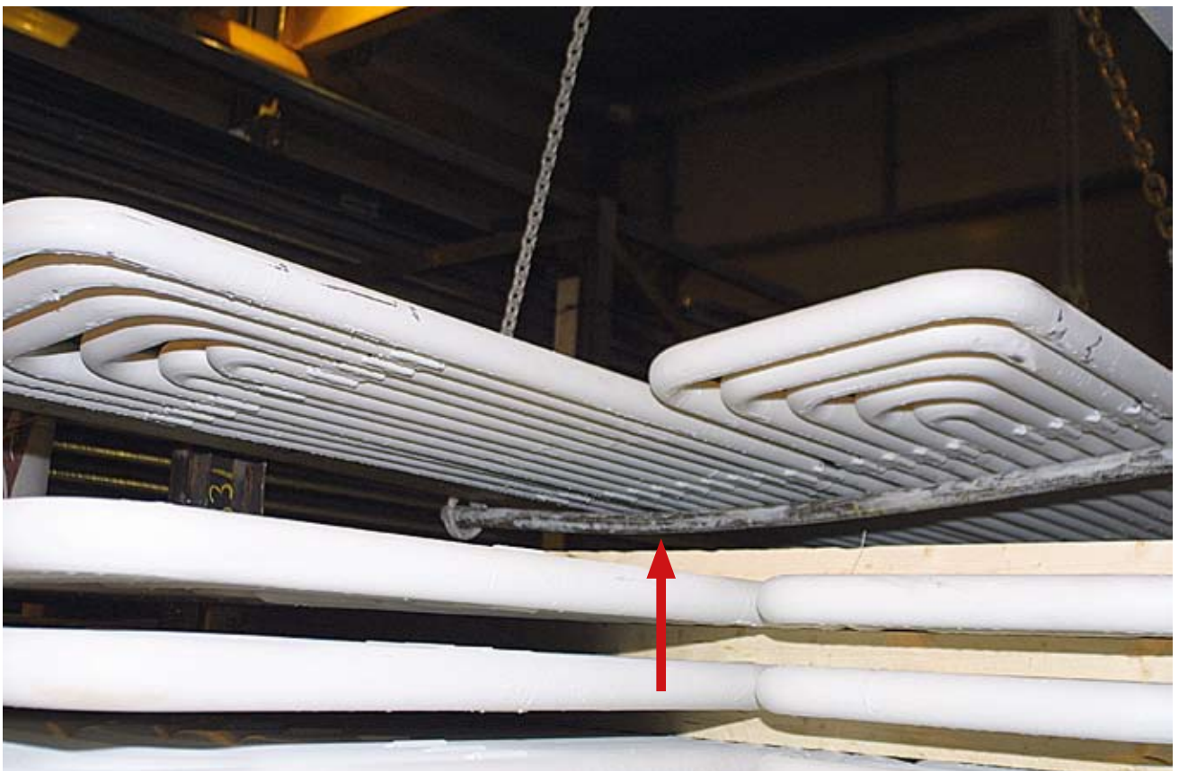
Kuva 4. Elementin suljetun kierron päästä elementtiä nostettiin putkiston alle työnnetyn metallitangon päihin kiinnitetyistä nostokoukuista, joihin kiinnitetyt kettingit yhtyvät samaan päärenkaaseen (punainen nuoli).
