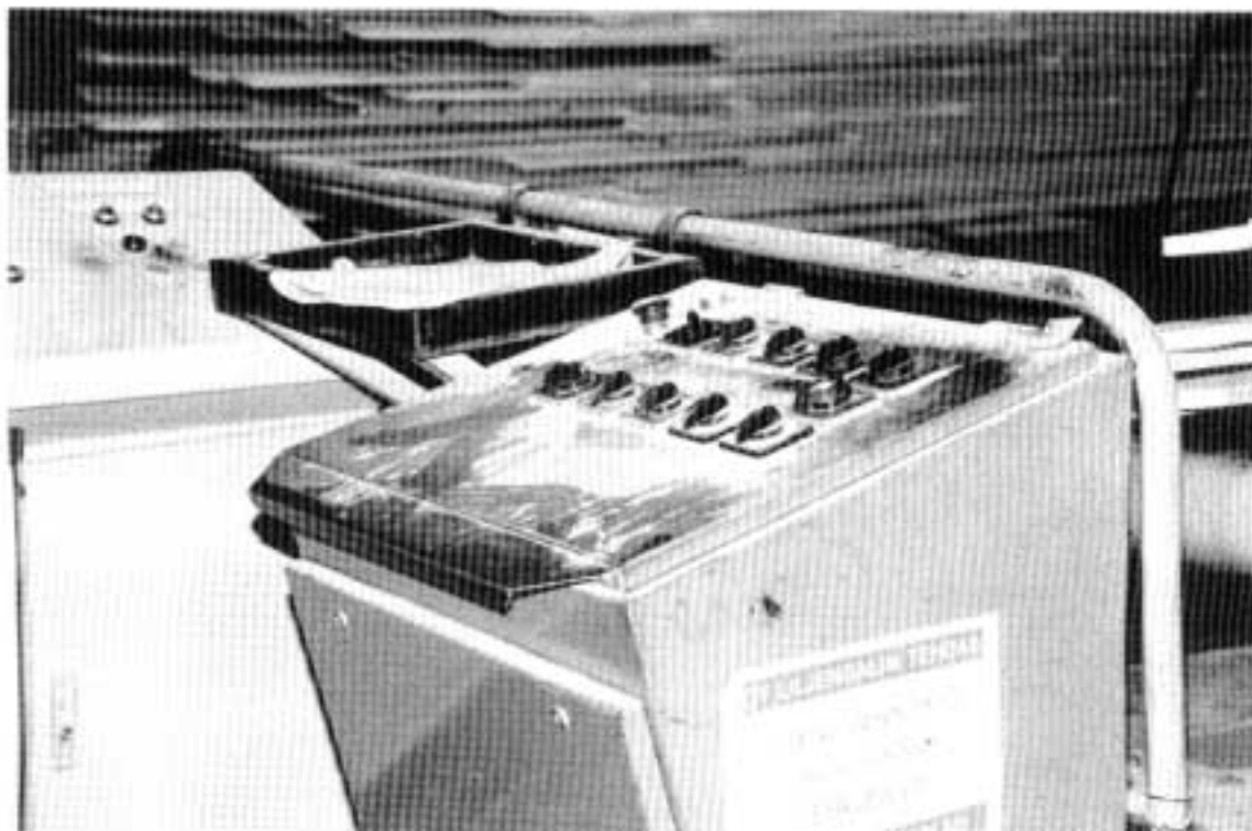
Kuva 5. Koneen ohjauspulpetti, jonka vasemmassa yläkulmassa olevan kuljetinautomatiikan ohjauskytkimen kääntäminen O-asentoon oli tyypillinen varmistustapa häiriöitä tutkittaessa.
