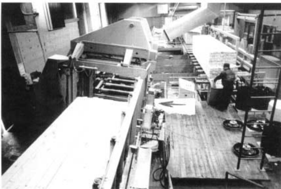
Kuva 2. Yleiskuva automaattisesta vannetuslinjasta. Uhri kurotti vannetuskoneen sisälle nuolella merkitystä aukosta kahden vannetusyksikön rakenteiden välissä.
