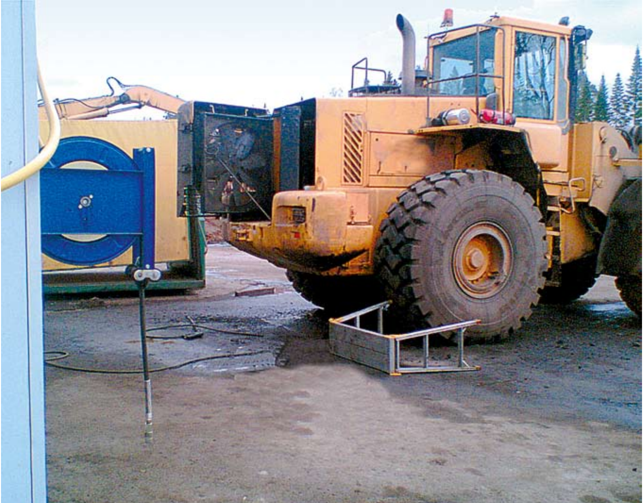
Kuva 1. Todennäköisesti NN putosi käyttämältään alumiinipukilta kaataen sen samalla pudotessaan tai sitten pukki kaatui tasapainonsa menettäneen NN:n alta, jolloin myös NN putosi asfaltille.
