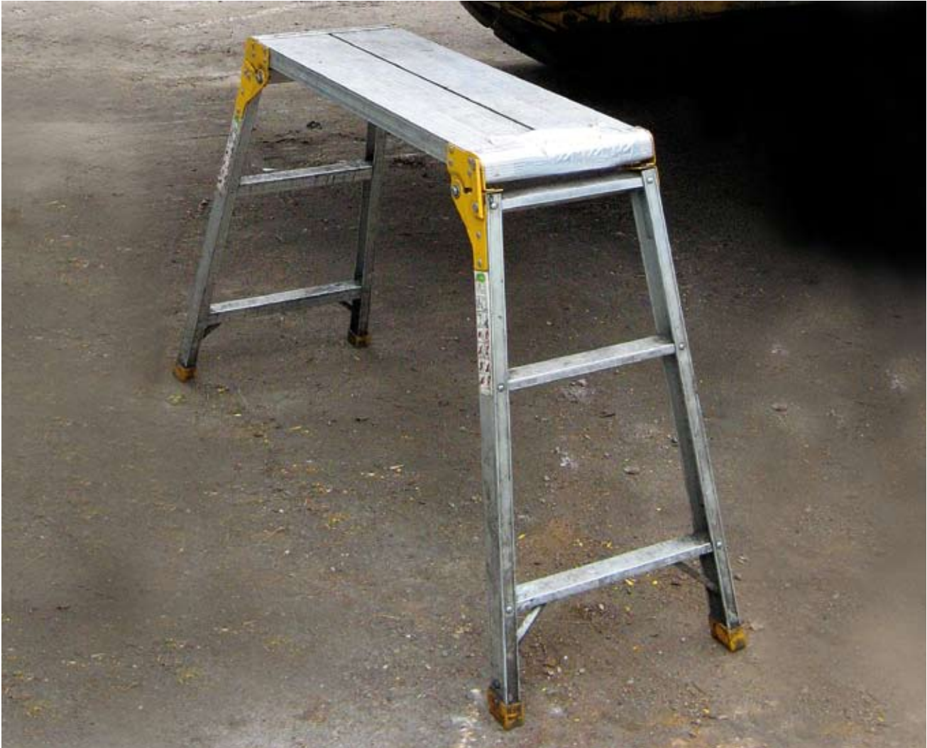
Kuva 2. NN käytti työtasonaan ammattikäyttöön tarkoitetulla painepesurilla työskentelyyn huonosti soveltuvaa ja vaarallista alumiinipukkia.
