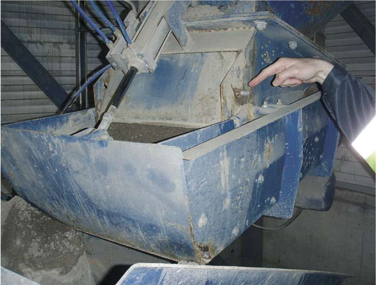
Kuva 1 Sormi osoittaa säätöruuvia, jolla säädettiin kuljettimen tehoa.
