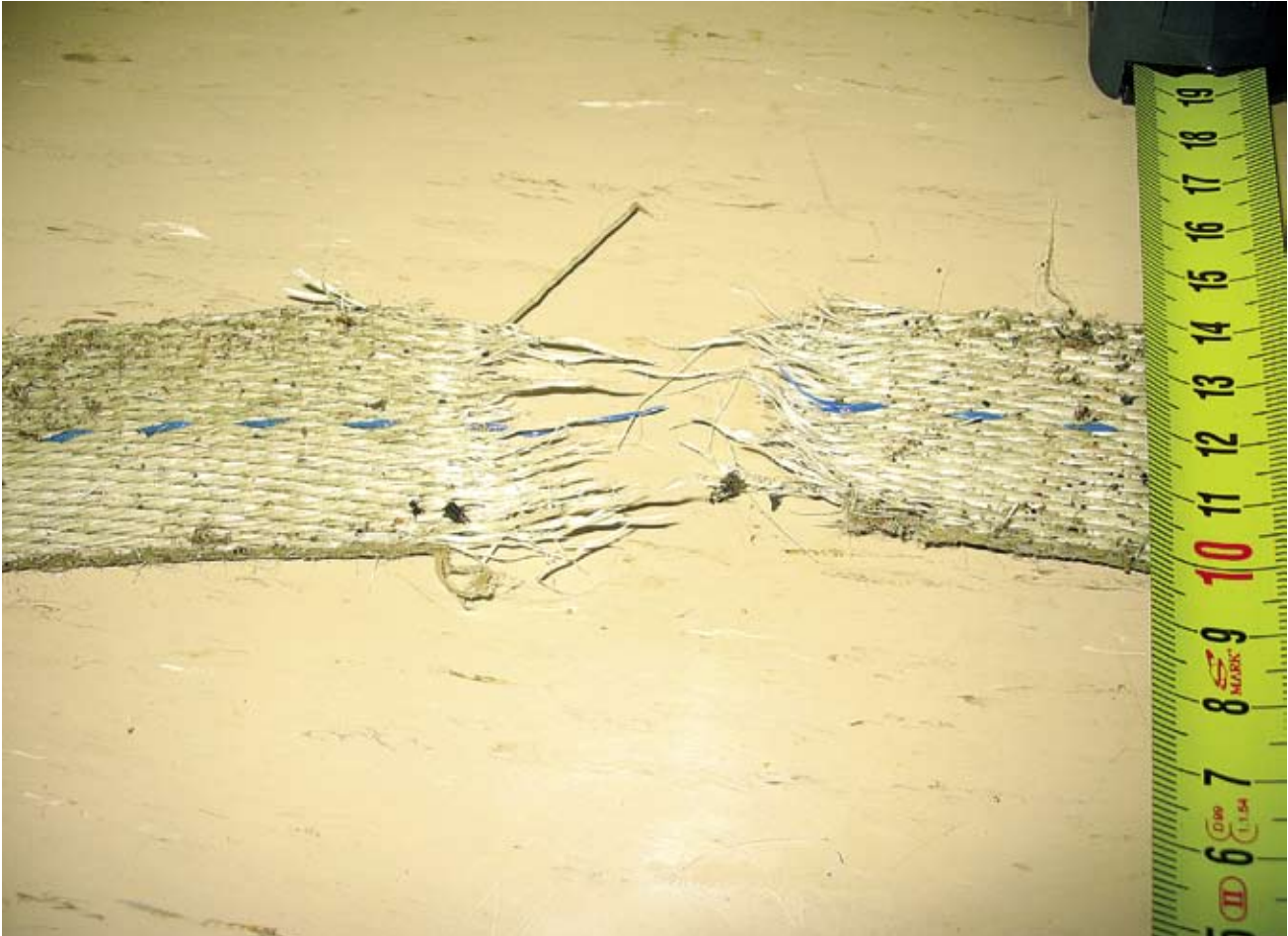
Kuva 3 NN:n käyttämä vetohihna tapaturman jälkeen.
