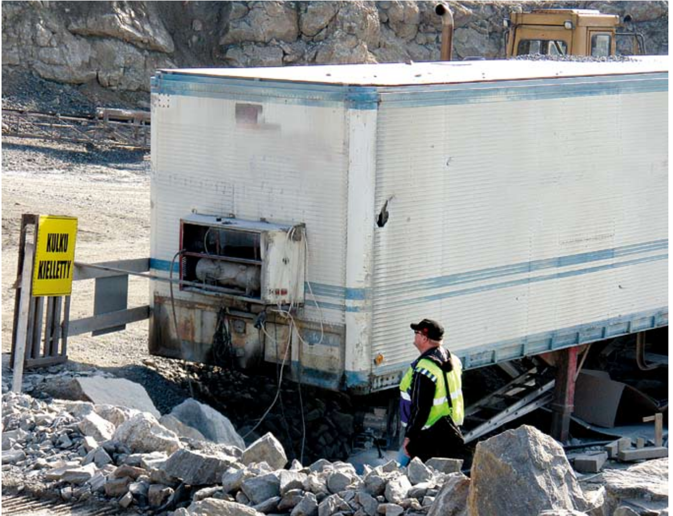
Kuva 2. Varastokontin pääty, jonka vierestä NN nousi pyöräkuormaajan ajoreitille (lavastettu tilanne). Kuvan vasemmassa reunassa näkyvä kulkueste on lisätty tapaturman jälkeen.
