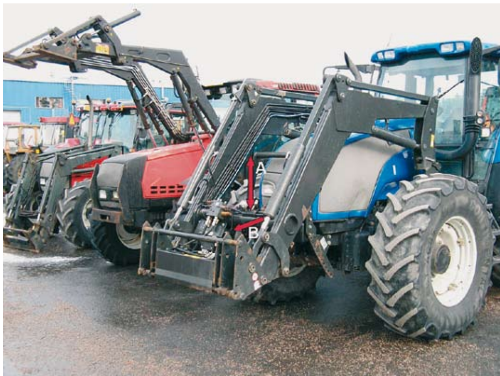
Kuva 1. Kuva vastaavanlaisesta traktorista. NN työskenteli tapahtumahetkellä ylösnostetun etukuormaajan ja koneen puskutuen välissä (nuoli A). Ilmeisesti hänen tarkoituksenaan oli vaihtaa etukuormaajan aisojen jousitusjärjestelmän paineakku (nuoli B).
