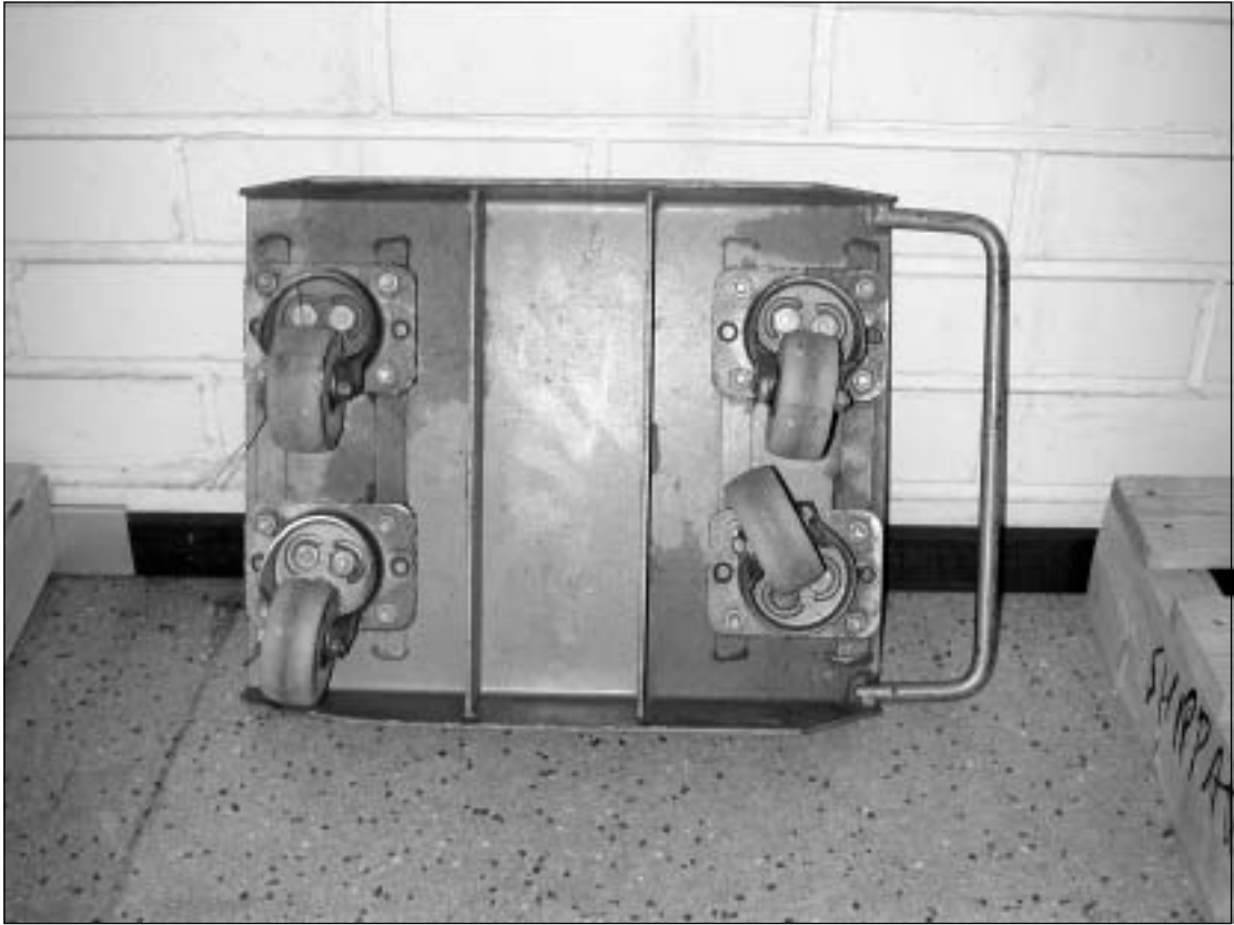
Kuva 3. Siirtoalusta kuvattuna alta päin. Kuvasta näkyy se, miten pyörät saattavat vapaasti asettua hyvin moneen asentoon alustan alla.
