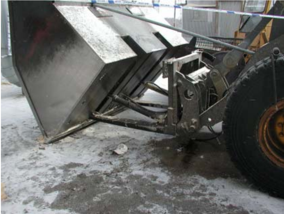
Kuva 1. Kauha siinä asennossa, johon se oli nostettu toisella pyöräkuormaajalla. Tämä asento on todennäköisesti lähellä sitä asentoa, johon NN oli sen asettanut ennen huoltotyötä. Kauha on vasta tapaturman jälkeen tuettu metalliputkella.
