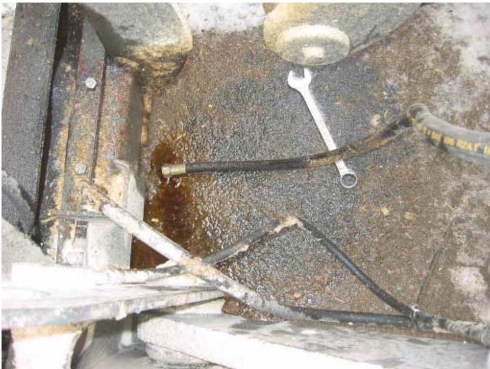
Kuva 2. Irrotettu hydrauliletku ja NN:n käyttämä kiintoavain.
