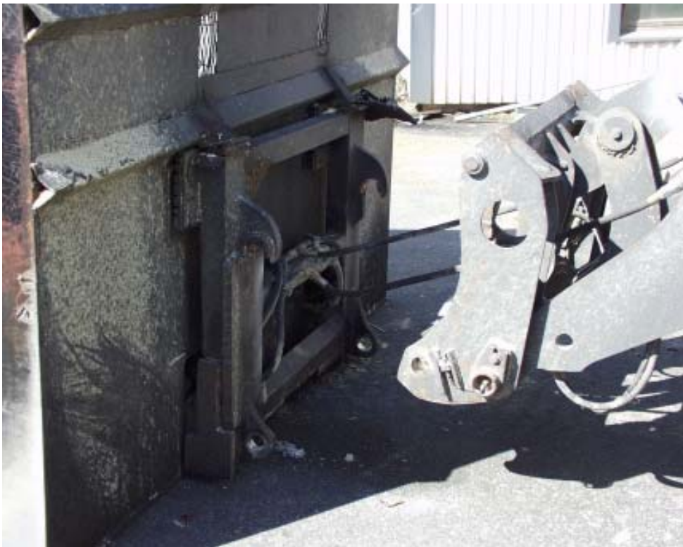
Kuva 4. Turvallinen huoltoasento, jossa kauha on irrotettu pikakiinnityslaitteesta.
