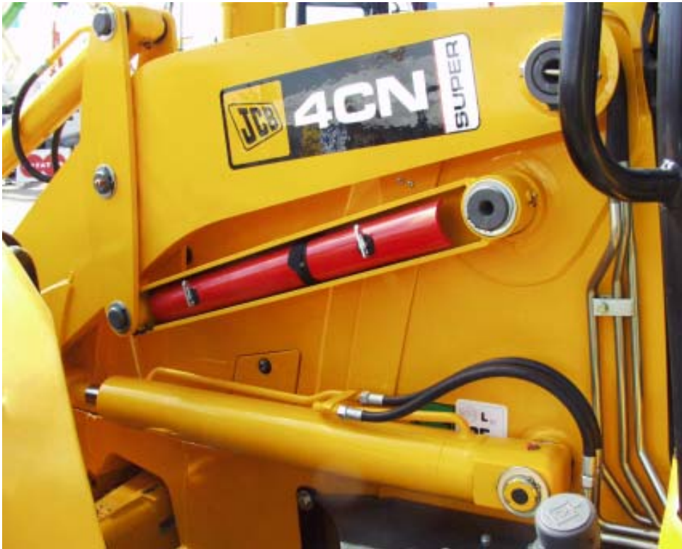
Kuva 5. Esimerkki erään koneen rakenteissa olevasta hydraulisylin- terin männänvarren ympärille asennettavasta mekaanisesta tues- ta.
