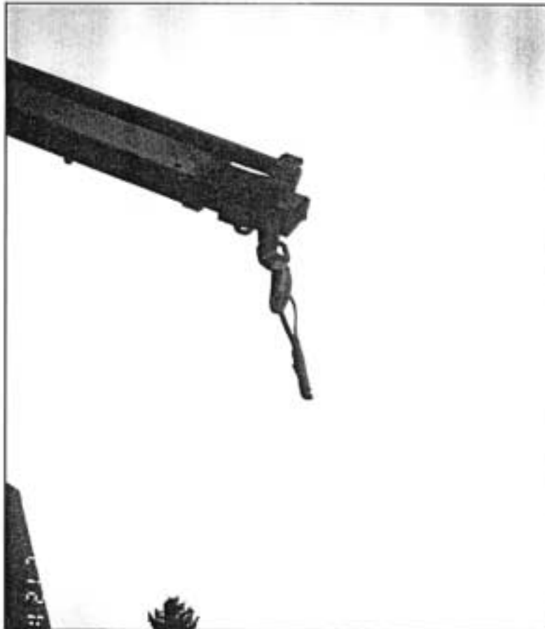
Kuva 2. Katkennut nostovyö auton nosturin koukussa.
