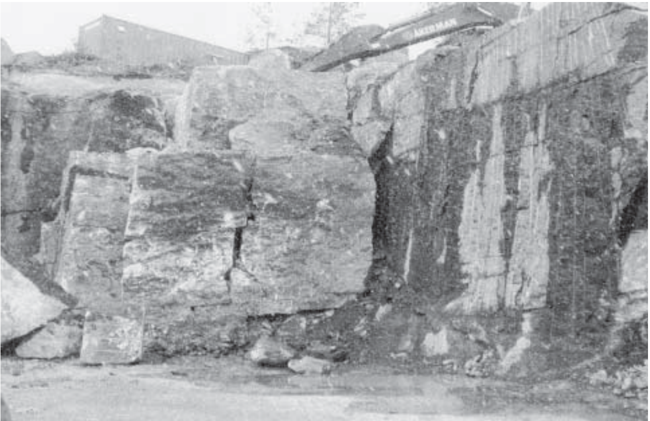
Kuva 1. Näkymä louhokselta, jossa tapaturma sattui. Edessä näkyvä, keskeltä haljennut kallioseinämä vastaa dimensioiltaan kallionosaa, josta onnettomuustilanteessa irtosi loh-kare. Vaarsinainen tapahtumapaikka oli kuvia otettaessa jo louhittu pois.
