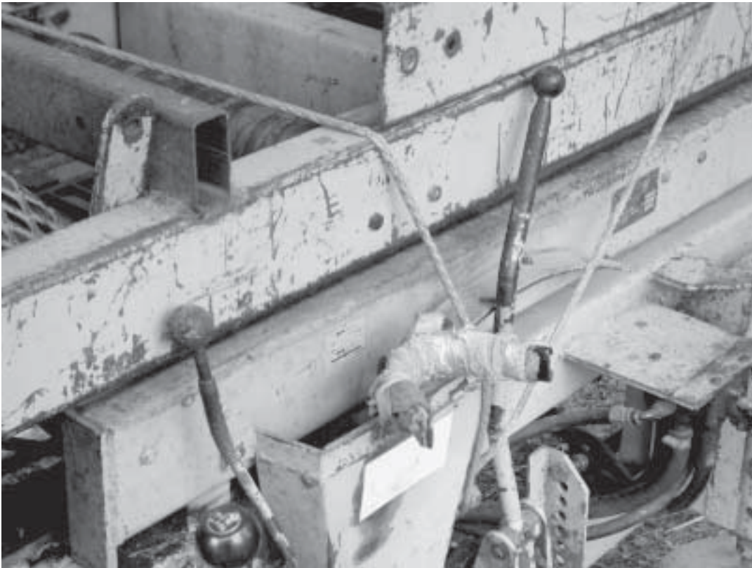
Kuva 2. Sirkelin tukkipöydän liikkeitä ohjataan jalalla käytettävällä hallintalaitteella.
