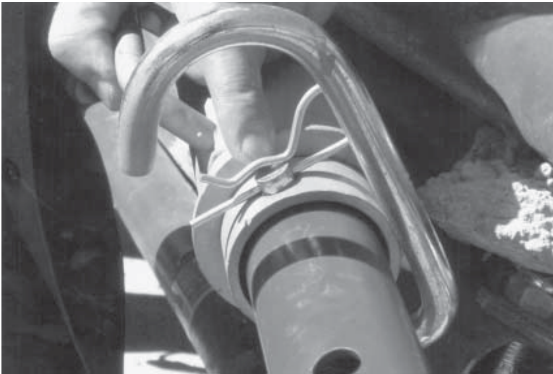
Kuva 6. Jos kiinnityssokka asennetaan näin ja jätetään lukitussokka pois, kiinnityssokka voi pudota.
