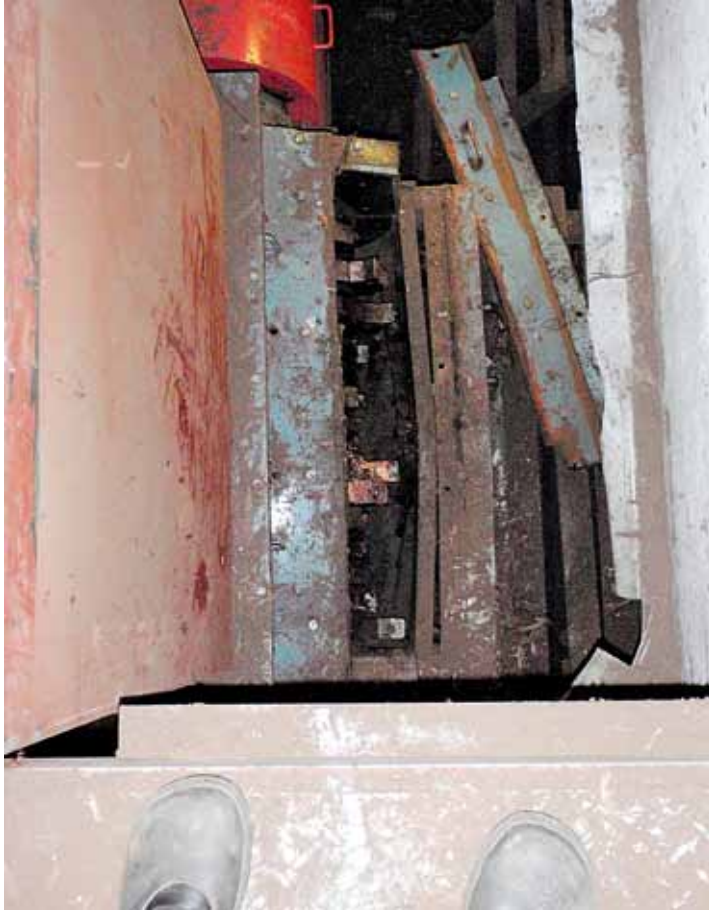
Kuva 3. Hoitotason huoltoluukku oli suoraan pyörivän roottorin yläpuolella.
