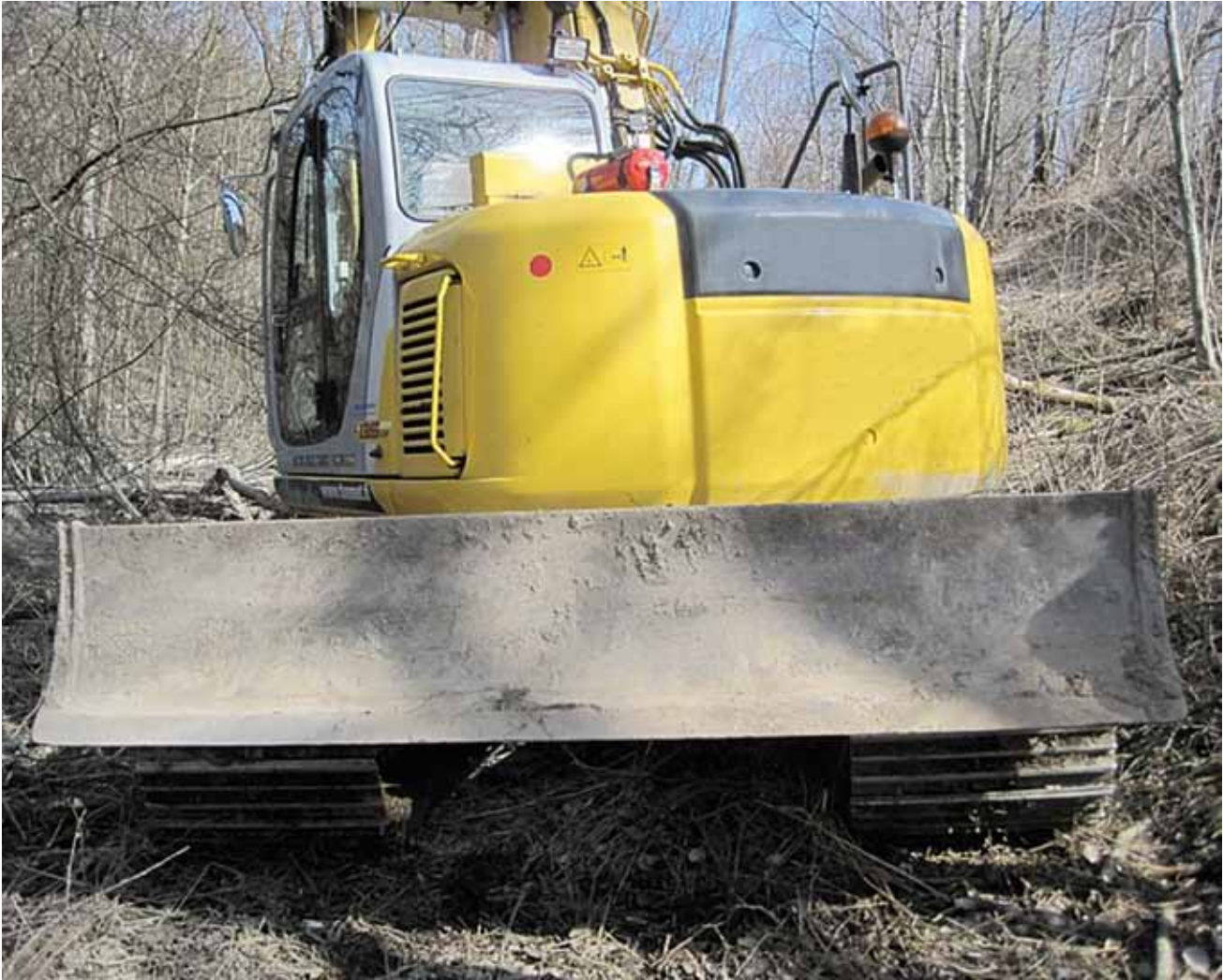
Kuva 1. Kaivinkoneen takalevy oli tapaturmahetkellä ylhäällä.
