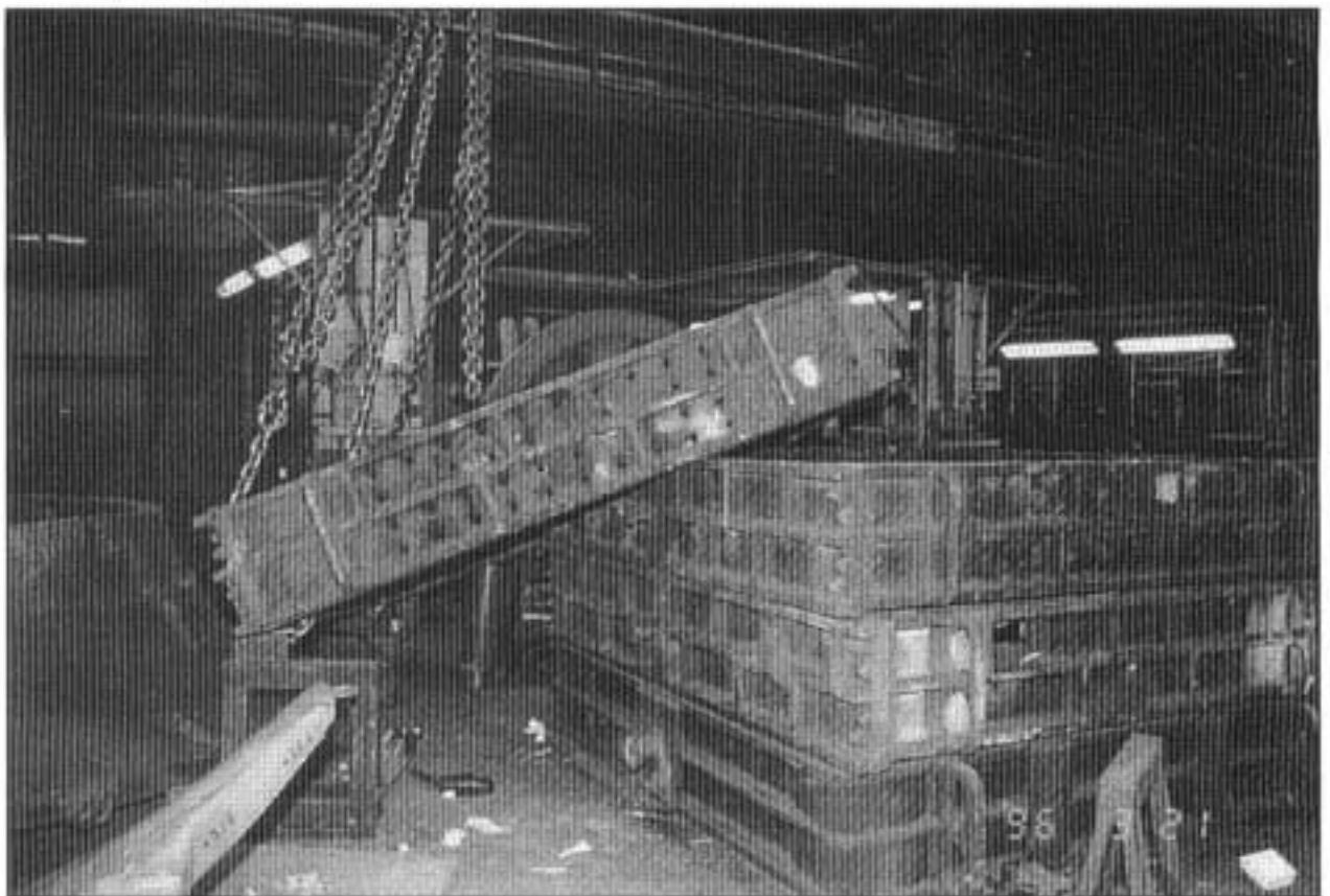
Kuva 2. Valukehän päältä pudonnut valukehä onnettomuuden jälkeen (ketjuja lisätty N.N:n irrottamisen yhteydessä).
