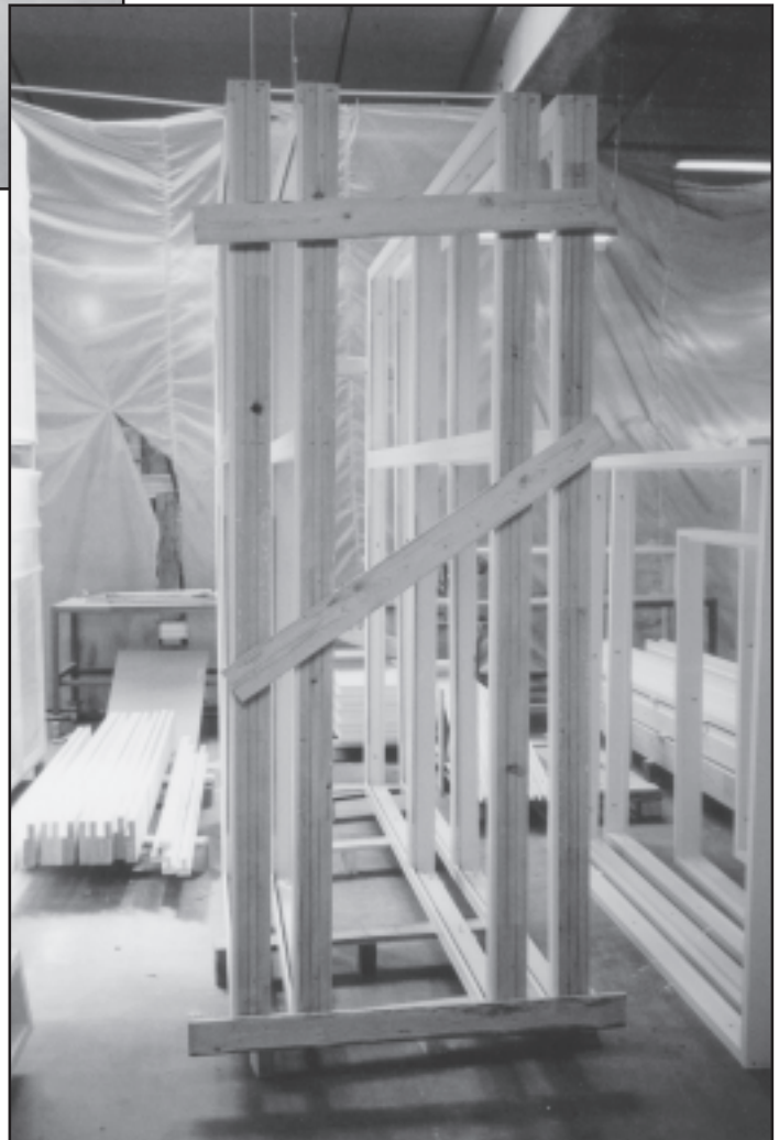
Kuva 4. Tapaturmassa kaatuneet ikkunat pakkausasennossa.
