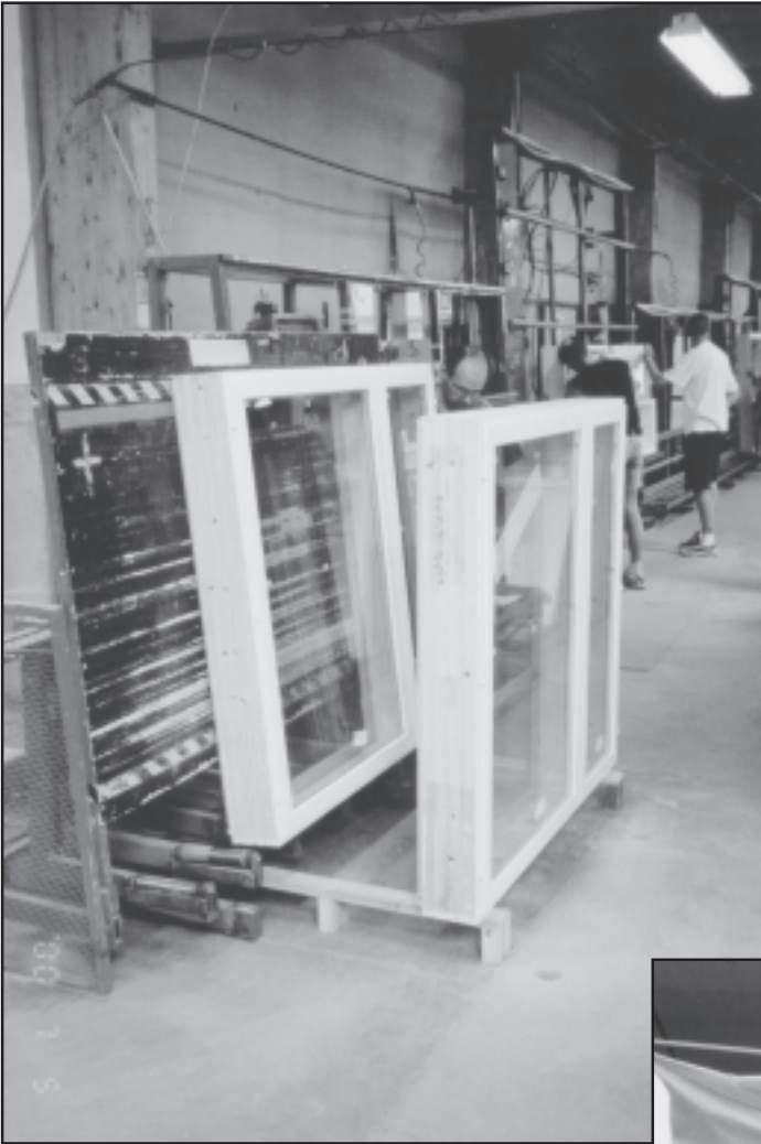
Kuva 3. Toinen ikkunan siirto pukkien varaan. Ikkunoita ei ole tuettu eikä reivattu, koska karmi on leveä ja ikkuna matala.
