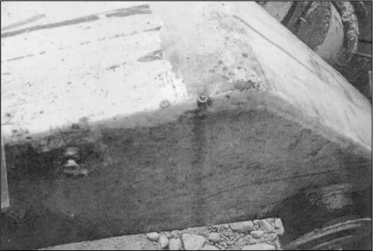
Kuva 3. Keskellä kuvaa pumppuauton puomiin syntyneet kaksi perättäistä oikosulukohtaa.
