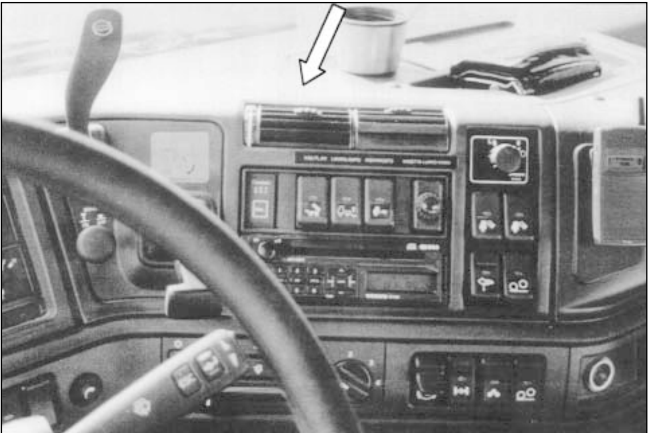
Kuva 2. Kasetin perälaidan lukon avauskytkin ohjaamossa.
