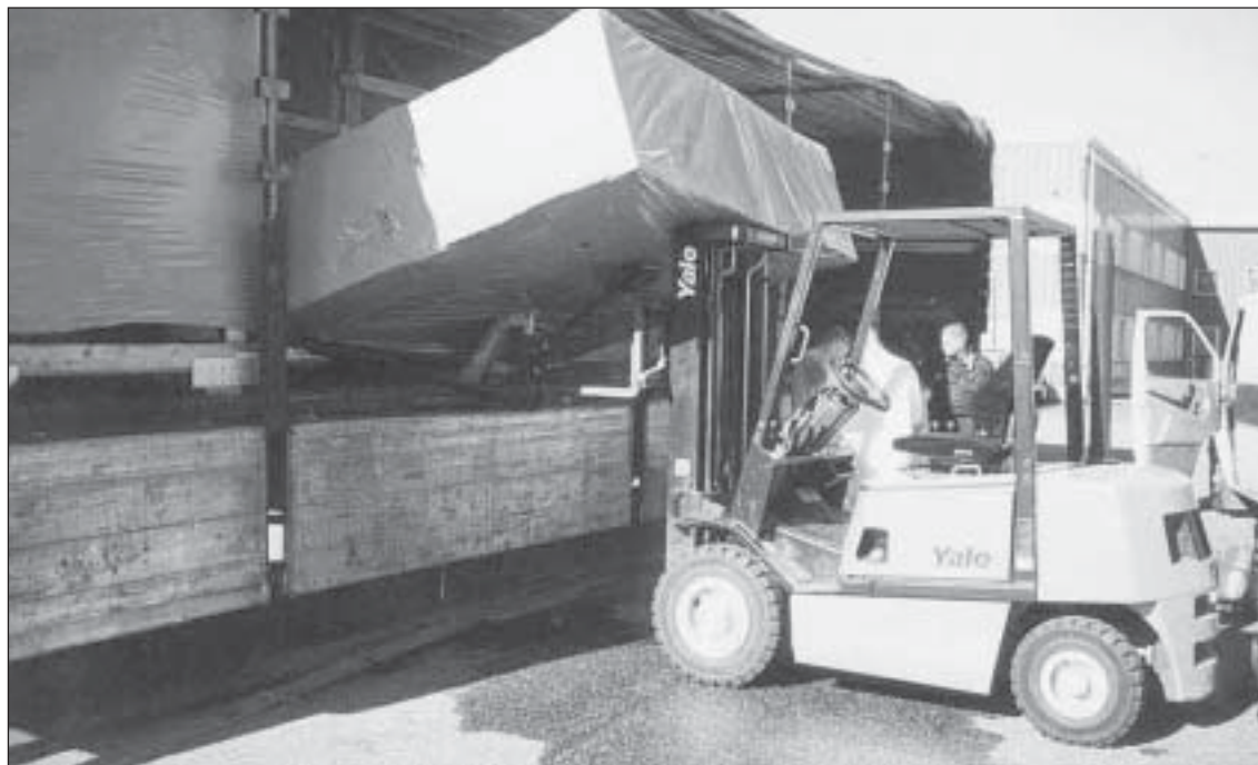
Kuva 4. Haarukkatrukki ja sen päälle kaatunut pakkauselementti.
