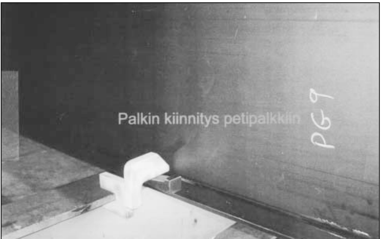
Kuva 3. Palkin kaatumista estävä kiinnitystapa.
