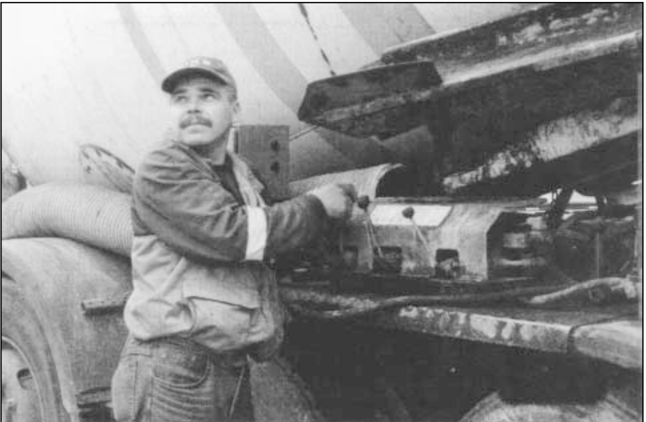
Kuva 2. Hihnakuuljettimen ohjaustilanne, jossa kuljettaja on osittain selin kuljettimeen nähden.
