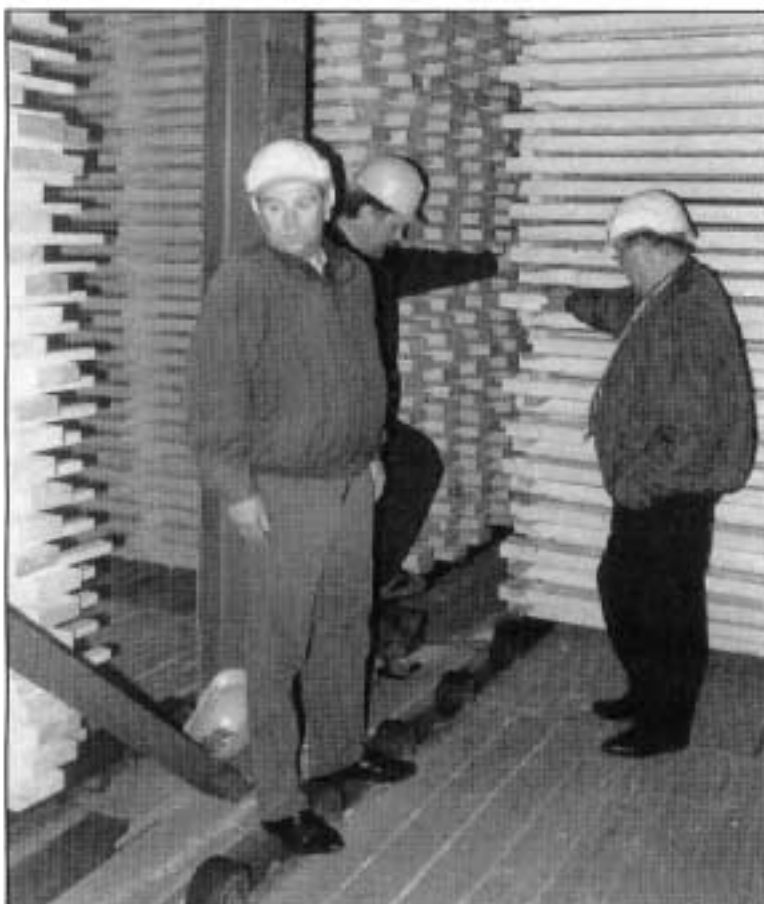
Kuva 4. Työntekijä jäi pystypalkin ja paketin väliin (mies vasemalla).
