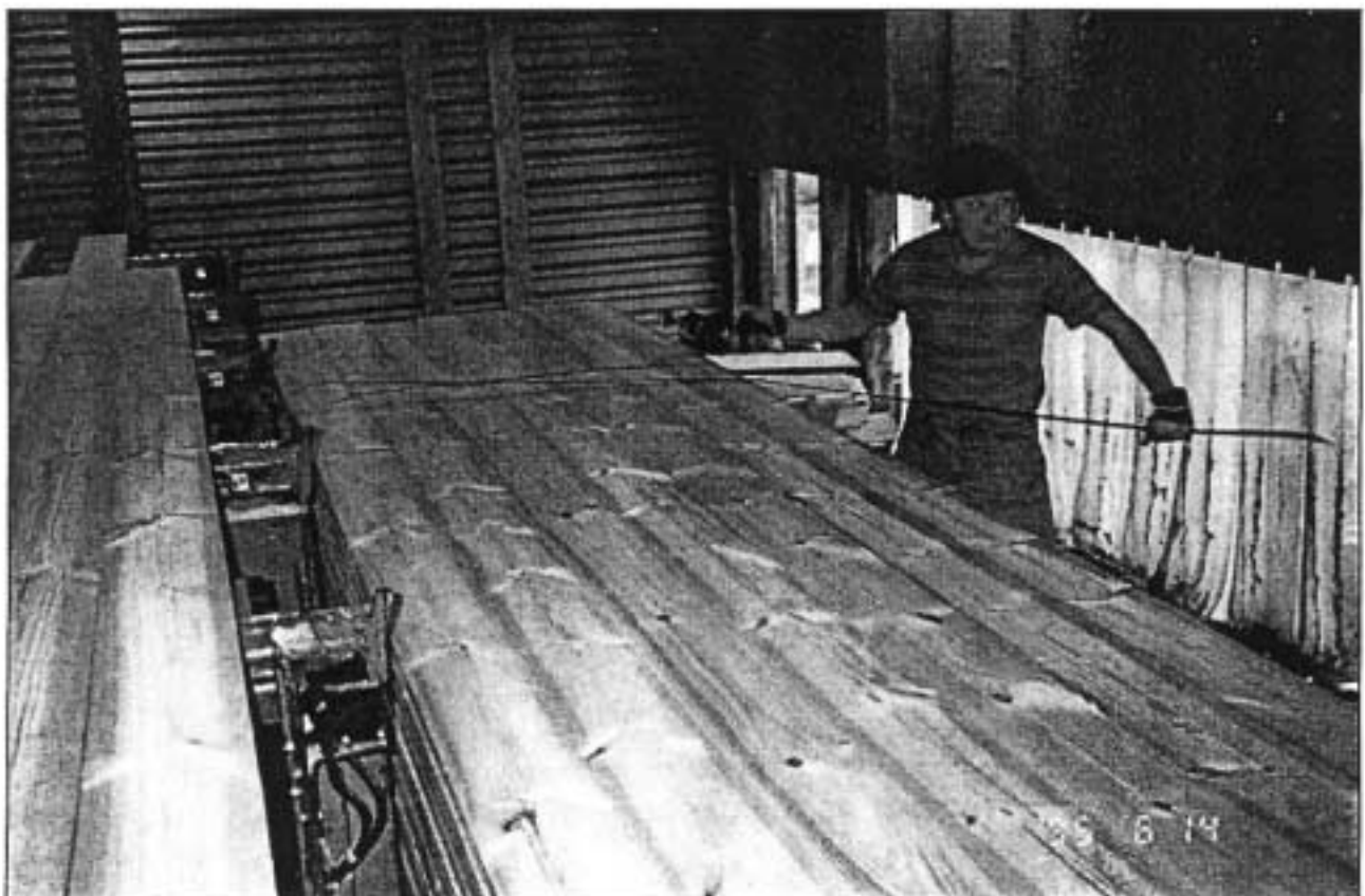
Kuva 3. Vanteen vetäminen kelaalta vanteen katkaisun jälkeen.
