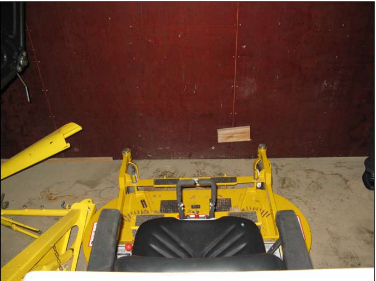
Kuva 1. Näkymä NN:n ohjaaman ruohonleikkurin kuljettajan perspektiivistä. Kyseessä on ns. sauvaohjattu etuleikkuri, jota ohjataan edessä näkyvillä sauvoilla, eikä siinä ole lainkaan ohjauspyörää.
