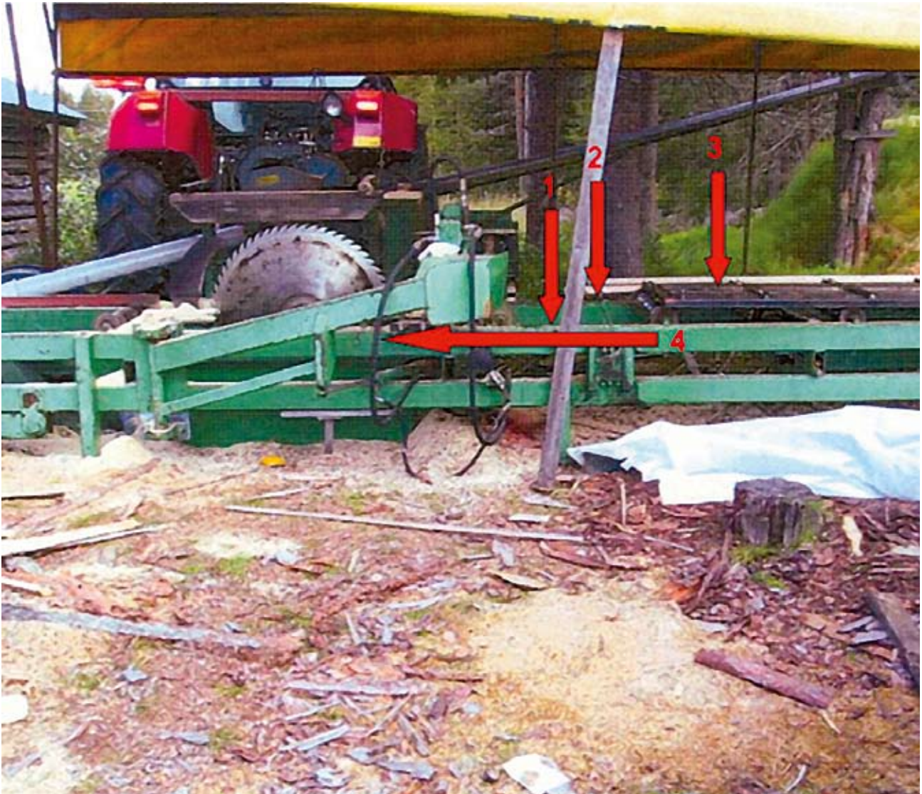
Kuva 1. NN huomasi sahauspöytää liikuttaneen ketjun olevan löysällä, minkä johdosta hän kurkotti ohjauspaikalta sahan runkopalkin yli kiristääkseen sahan toimintaan liittyvään hydraulipumppuun kuuluvaa pulttia, joka sijaitsee nuolen 1 esittämässä kohdassa n. 20 cm:n korkeudella maanpinnasta. Tällöin hän osui kehollaan tai jalallaan sahauspöydän liikettä ohjaavaan käsikäyttöiseen hallintalaitteeseen (2), minkä johdosta sahauspöytä (3) lähti liikkeelle osuen samalla NN:ään. NN menetti tasapainonsa ja joutui sahauspöydän mukana pää edellä pyörivään terään (4).
