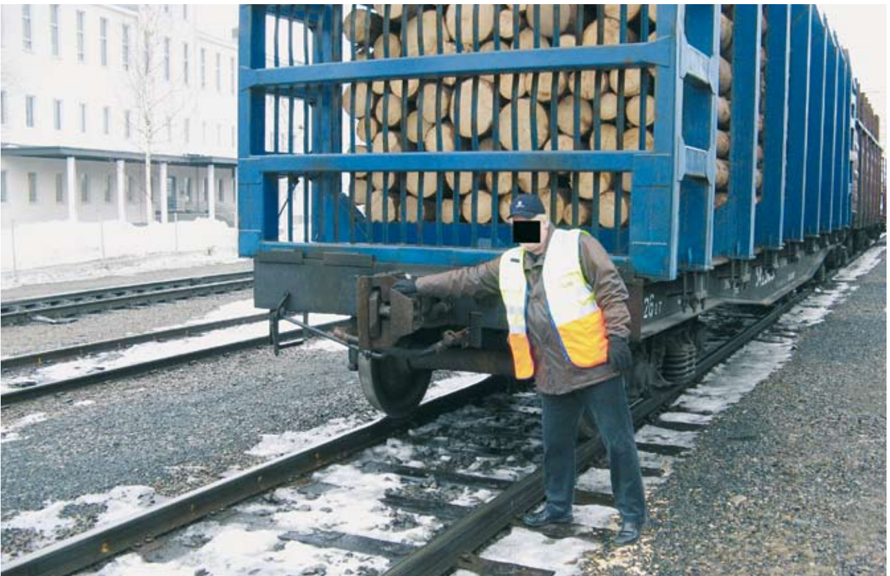
Kuva 3. Todennäköisesti tilanteen poikkeuksellisuudesta johtuen vaihtotyönjohtaja NN seurasi vaunujen kohtaamista liian läheltä tai sitten jopa meni tietoisesti liikkuvan Vgk-vaunun ja Lgjn-vaunun väliin tarkoituksenaan ohjata keskuspuskinta kohti koukkaa ennen vaunujen kohtaamista.
