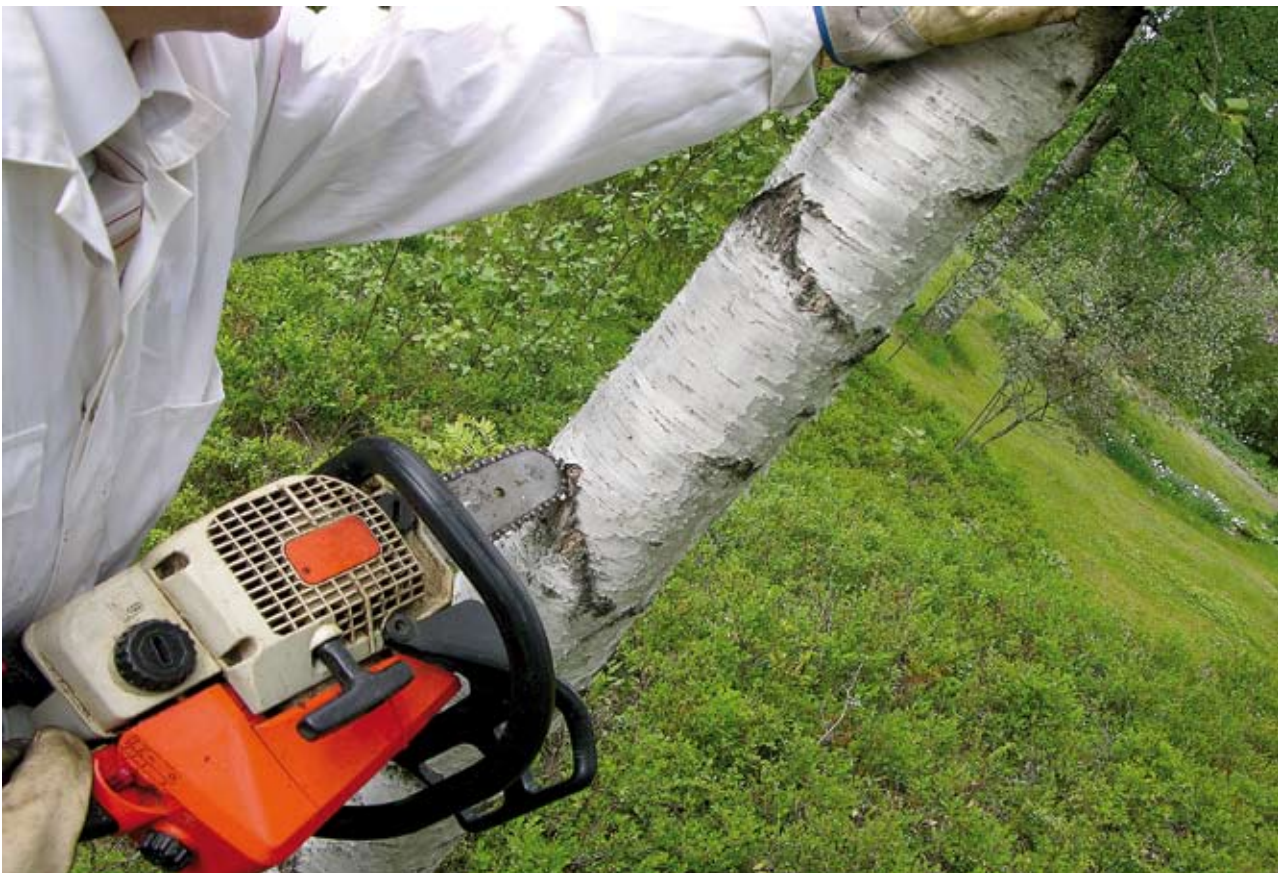
Kuva 2. Lavastettu kuva NN:n mahdollisesta sahausasennosta ennen tapaturmaa. NN:n tapaturmahetkellä käyttämä moottorisaha oli suurempi ja painavampi kuin kuvassa oleva moottorisaha. Sahaushetkellä saha on saattanut olla myös toisinpäin käsiotteella (takapotku).
