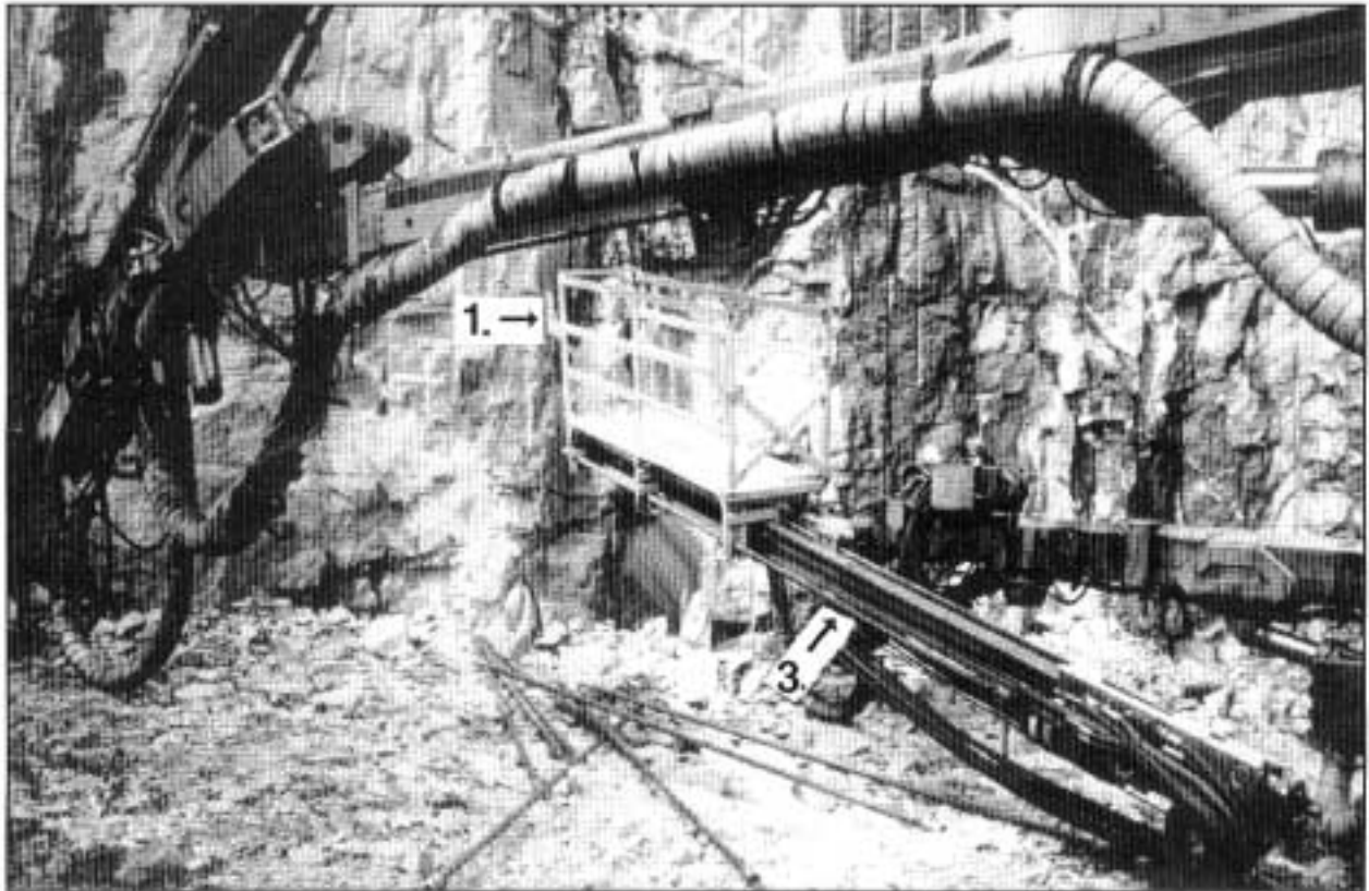
Kuva 3. Kori ja puomi työasennuksessa (lavastus onnettomuuden jälkeen, poratangot maassa).
