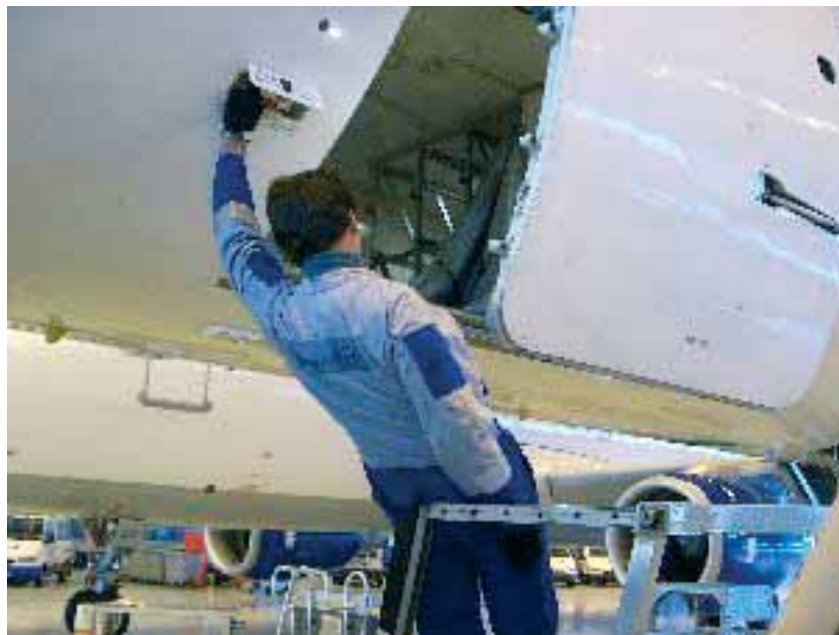
Kuva 4. Ruuman luukku suljetaan hihnakuormaimella seisten vaarallisessa työasennossa.
