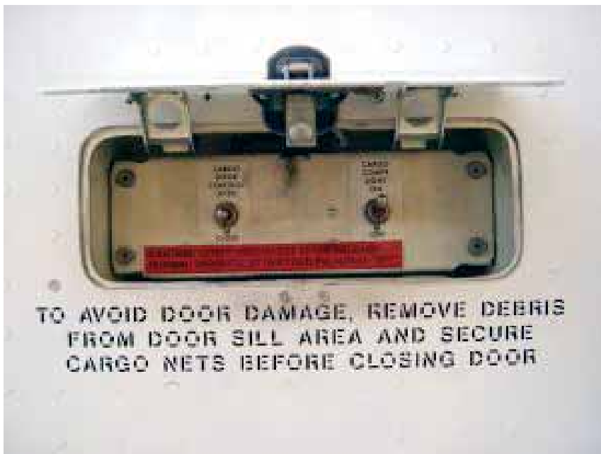
Kuva 2. Rahtiruoman luukkaa käytetään kytkimestä, joka on sijoitettu rahtiruoman luukun vasemmalle puolelle. Ajopaneelin kytkimien alapuolella tulee olla teksti, jossa varoitetaan kytkimen mahdollisesta viallisesta toiminnasta.
