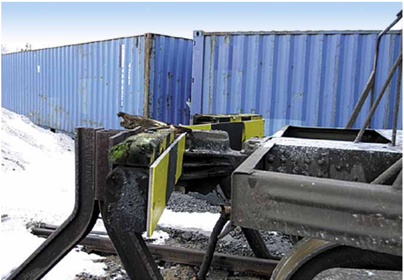
Kuva 4. Raiteen päässä olleen päätepuskurin lujuus ei riittänyt pysäyttämään kahden ylikuormassa olleen vatd –vaunun törmäystä rikkoutumatta.
