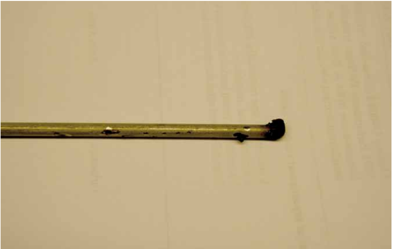
Kuva 2. Kiinnijumiutuneen sammutuspiiskan hitsautunut pää.
