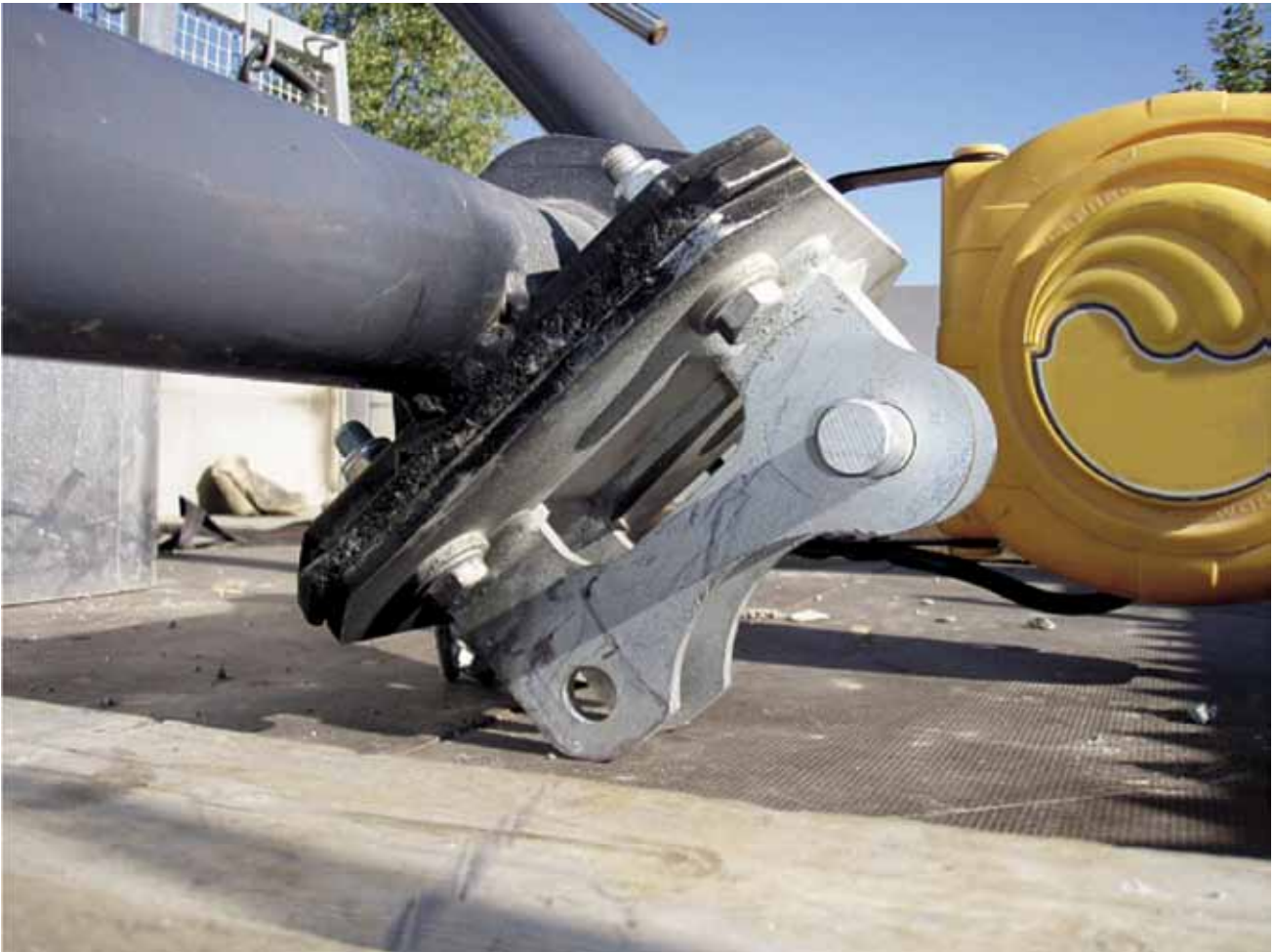
Kuva 3. Henkilönostimen korin mustaksi tummunut kiinnityslaippa tapaturman jälkeen.
