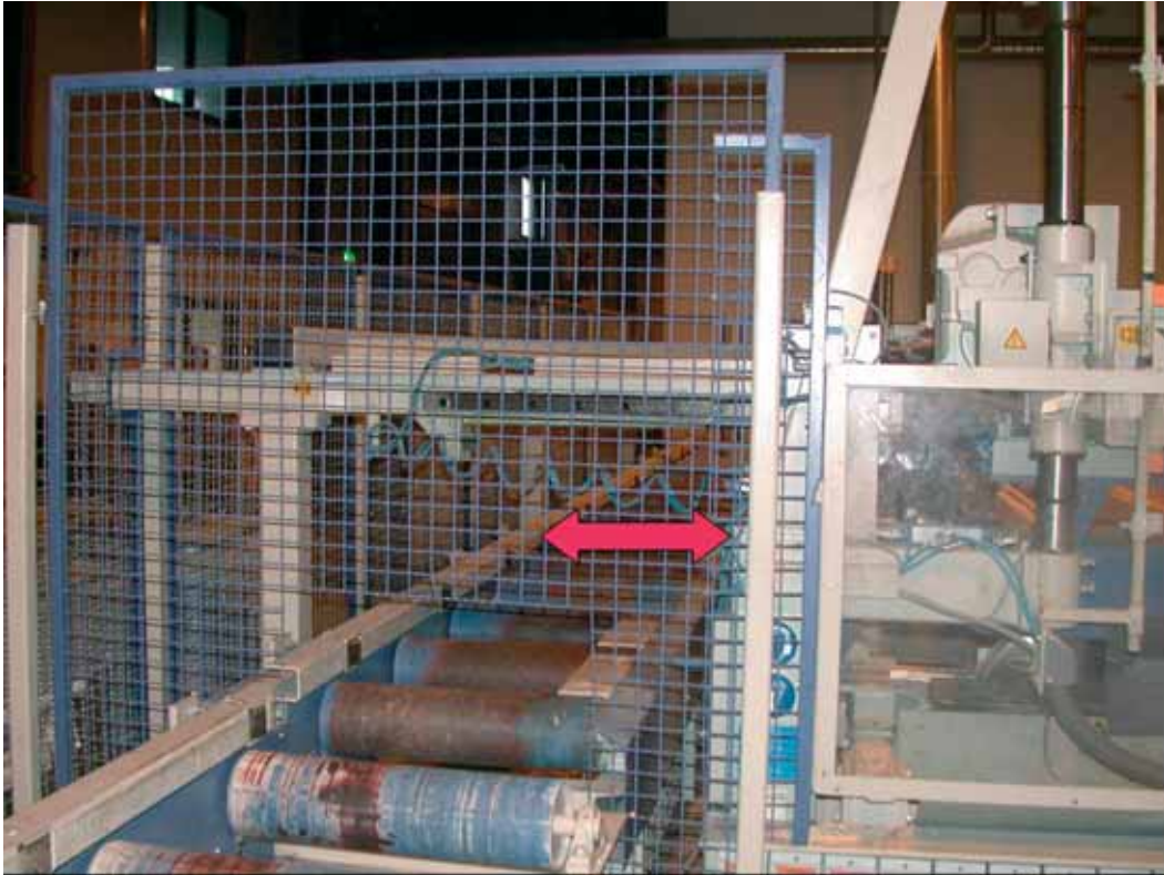
Kuva 1. Katkaisusaha tekee edestakaisen työliikkeen suojaverkon takana nuolen osoittamassa välissä. NN jäi puristuksiin katkaisusahan jälkeen olevan liimapuupalkkien työntäjän ja koneen runkorakenteiden väliin.
