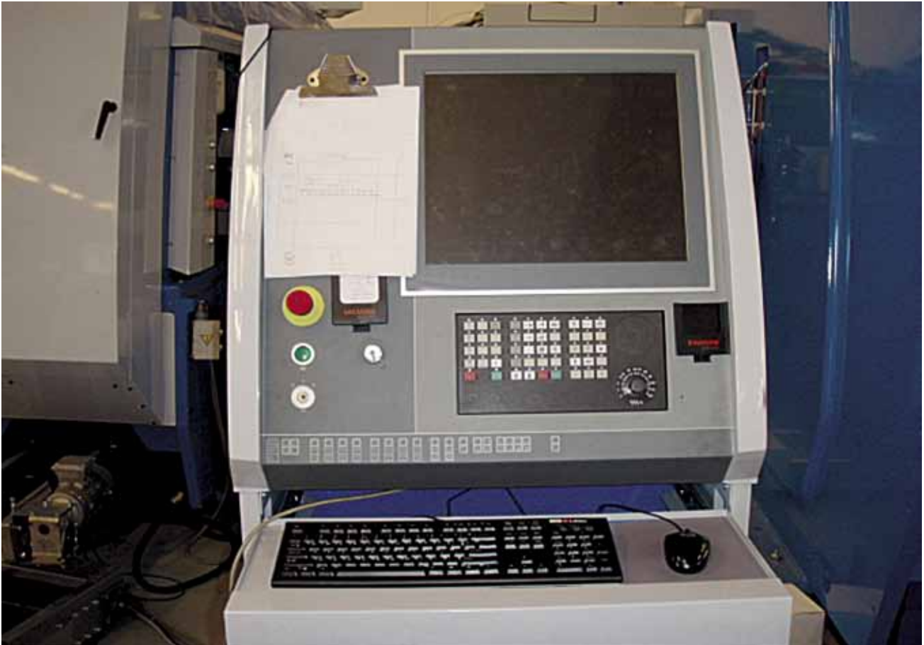
Kuva 3. Levyntööstökeskuksen käyttöpaneeli, jossa käynnistyskytkin ja hätäpysäytin ovat vierekkäin.
