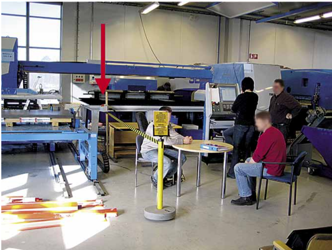
Kuva 1. Lavastettu tilanne, jossa opastettavat ja kouluttaja olivat tapahtumahetkellä. Nuoli osoittaa NN:n paikkaa juuri ennen tapaturmaa. Kouluttaja ei levykeskusta käynnistäessään havainnut NN:ää, koska käyttöpaneeli peitti näkyvyyden.
