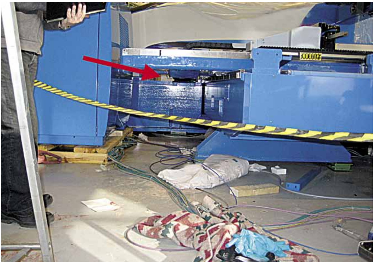
Kuva 4. Nuoli osoittaa väliä johon NN puristui (90 mm)
