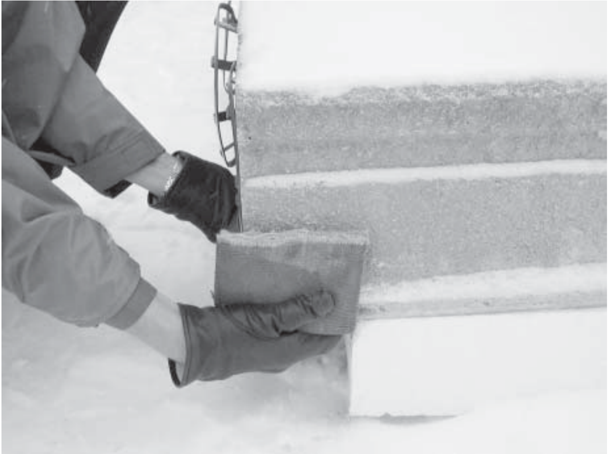
Kuva 3. Nostossa käytetyn vastaavanlevyisen nostoliinan sovittaminen ontelolaatan päähän.
