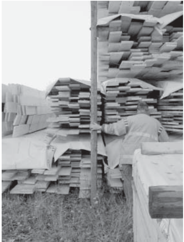
Kuva 2. Pystyyn jääneiden pakettien peräpäiden asennot verrattuna pakettiin, jonka päällä olivat kaatuneet paketit.
