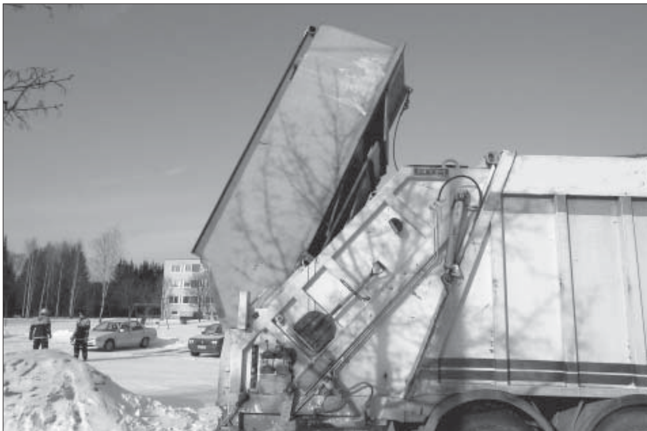
Kuva 1. Yleiskuva, jossa jätekontti kaatuneena eteenpäin jäteauton pakkaajassa. Tapaturman uhri puristui nuolen osoittamaan jätekontin ja -pakkaajan rakenteen väliin.
