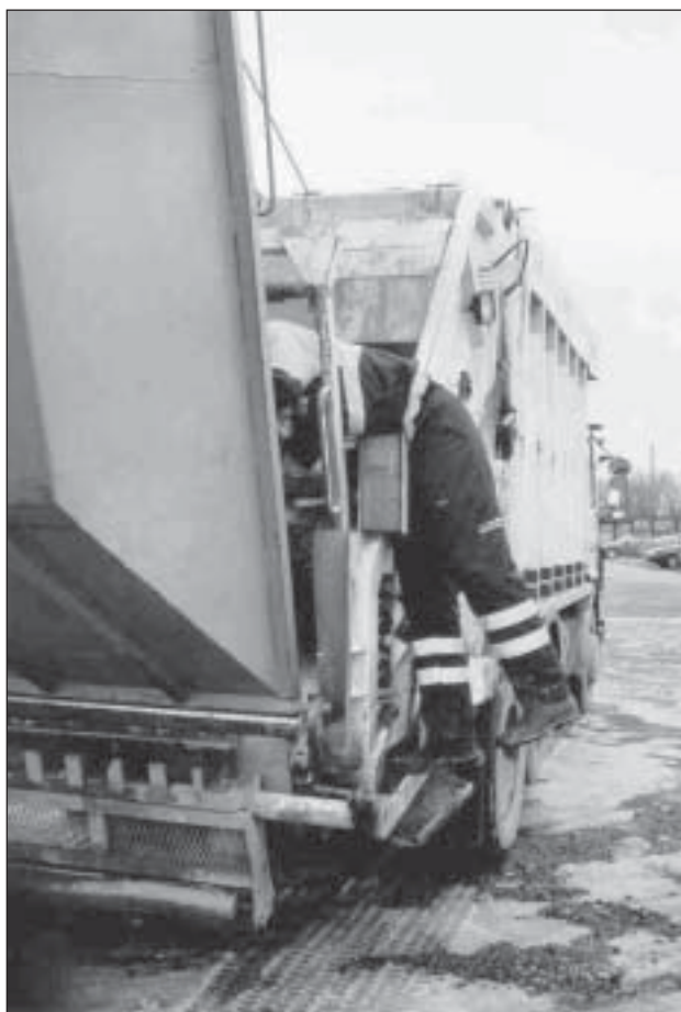
Kuva 1. Yleiskuva, jossa jätekontti kaatuneena eteenpäin jäteauton pakkaajassa. Tapaturman uhri puristui nuolen osoittamaan jätekontin ja -pakkaajan rakenteen väliin.
