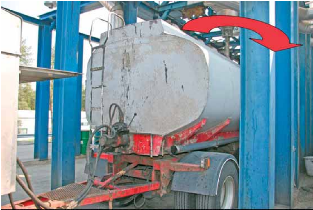
Kuva 1. NN putosi säiliön päältä n. 3 metrin korkeudesta, auton kulkusuuntaan nähden vasemmalta ensimmäisen täyttöluukun kohdalta.
