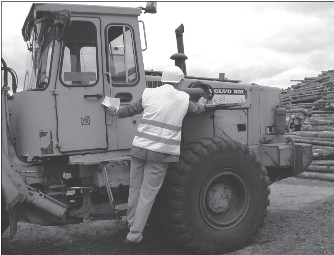
Kuva 2. Lavastettu tilanne astinlaudalle hyppäämisestä.
